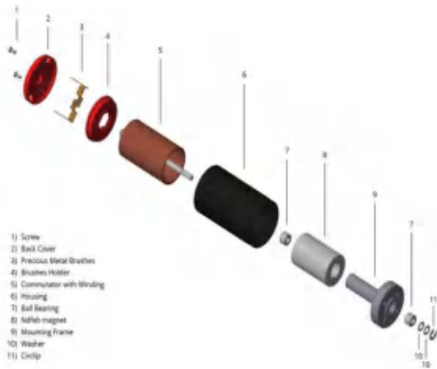
图 19: 有刷空心杯电机结构
