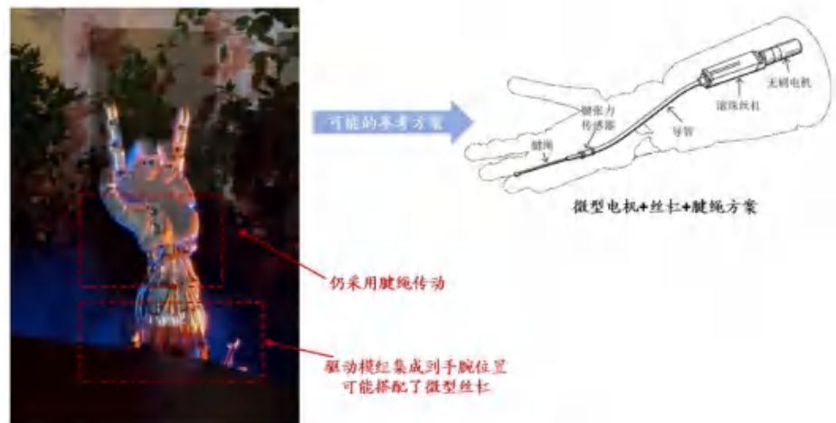
图 7: 特斯拉最新22自由度灵巧手可能采用了微型丝杠+腱绳的方案
