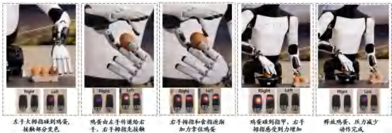
图 10：Optimus二代灵巧手拿起、传递、释放鸡蛋的精准力控过程
