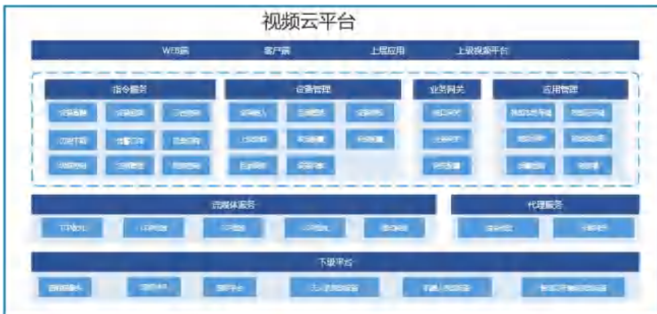
图 10 视频云平台架构图
